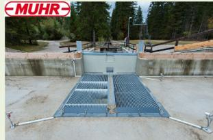
Abb. 4: Versuchsstand mit sohlnaher Abstiegsöffnung
