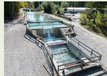
Abb. 5: Versuchsstand mit oberflächennahe Abstiegsöffnung
