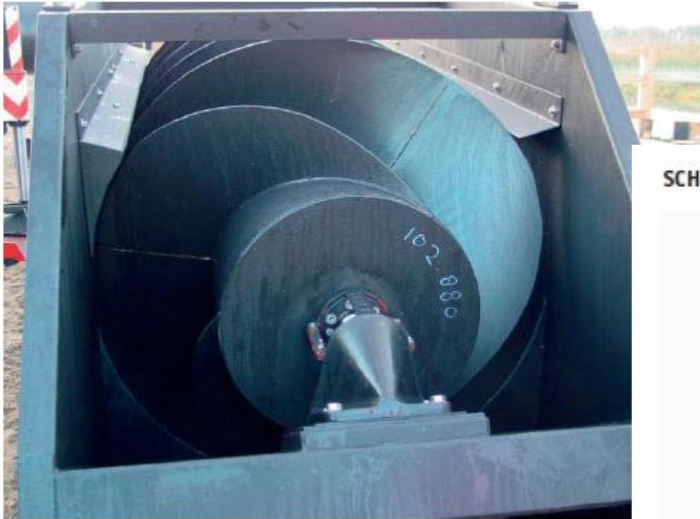
SCHROEFTYPE CENTRIFUGALE IMPELLER
